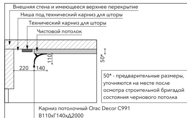
50\* - предварительные размеры, уточняются на месте после осмотра строительной бригадой состояния чернового потолка
