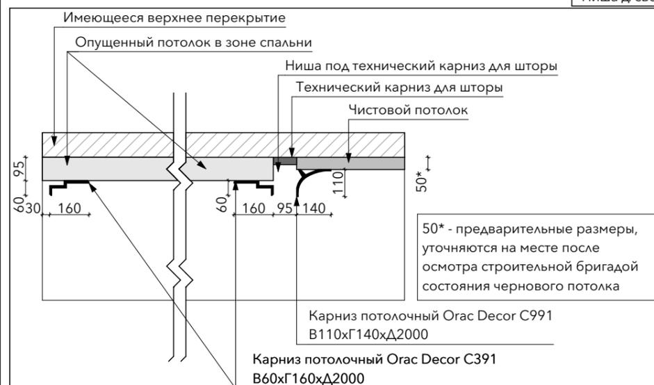
50\* - предварительные размеры, уточняются на месте после осмотра строительной бригадой состояния чернового потолка
