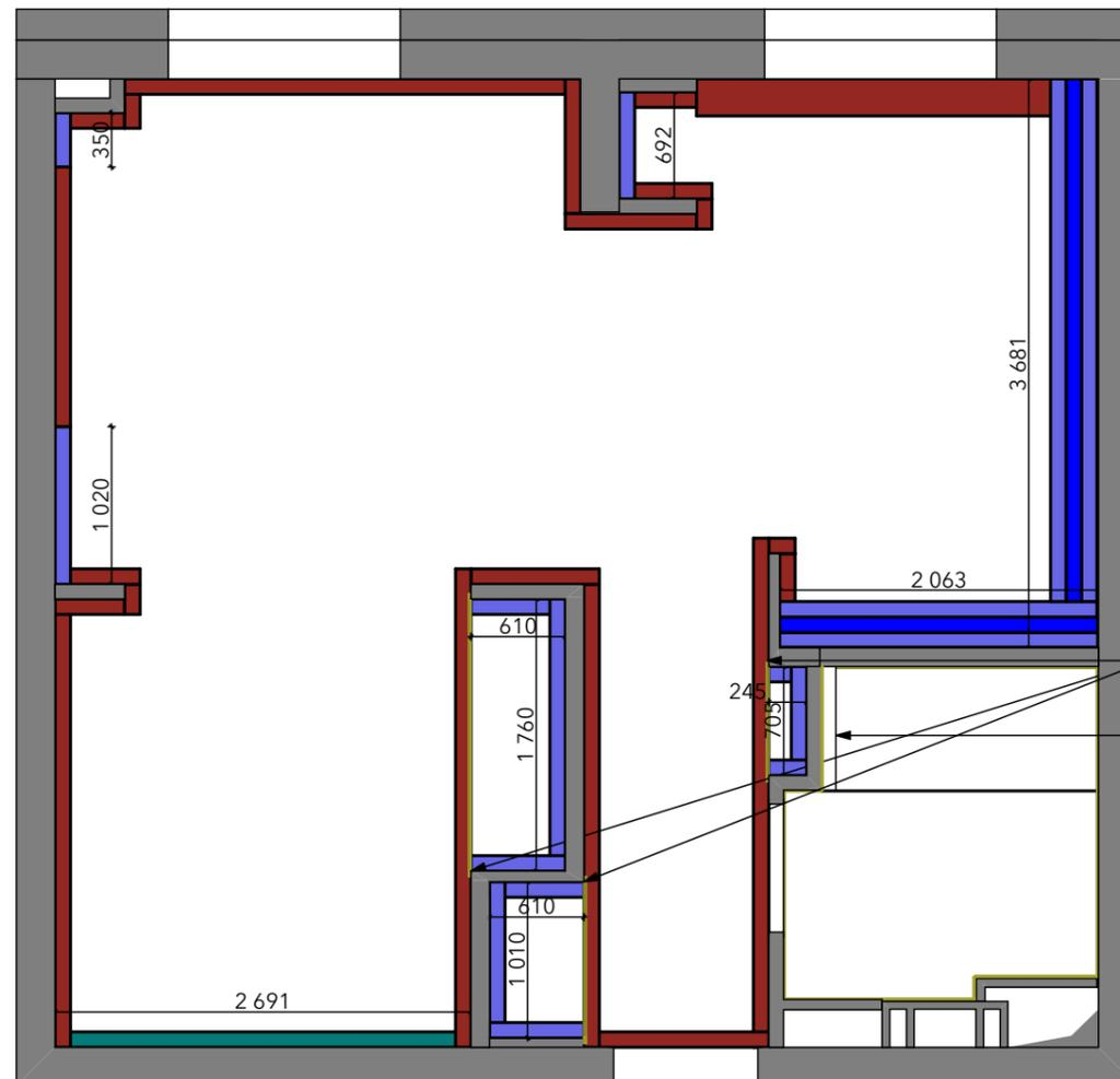
Молдинг вокруг (по бокам и сверху) встроенного шкафа. Закрывает щели между шкафом и стеной. Красится водоэмульсионной краской в два слоя в цвет стен.
