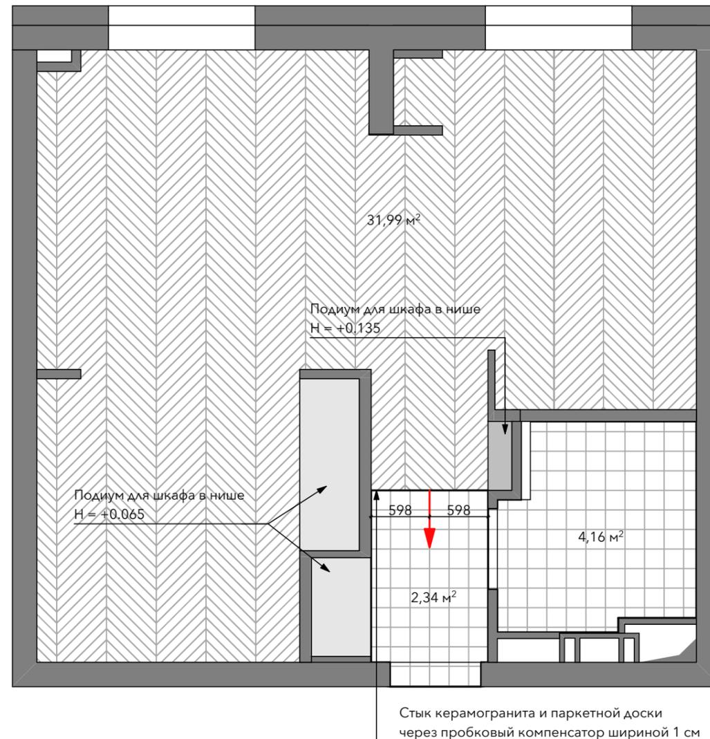
1. При устройстве стяжек учитывается разная толщина напольных покрытий.
